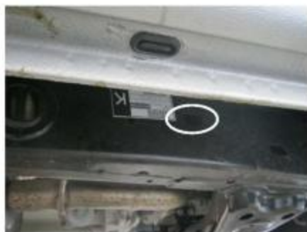
Рис.2 Установка шпильки закладной для переднего кронштейна
