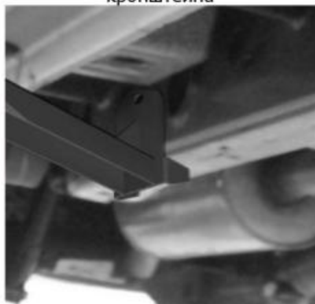
Рис.5 Установка заднего кронштейна
