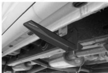
Рис.5 Установка заднего кронштейна
