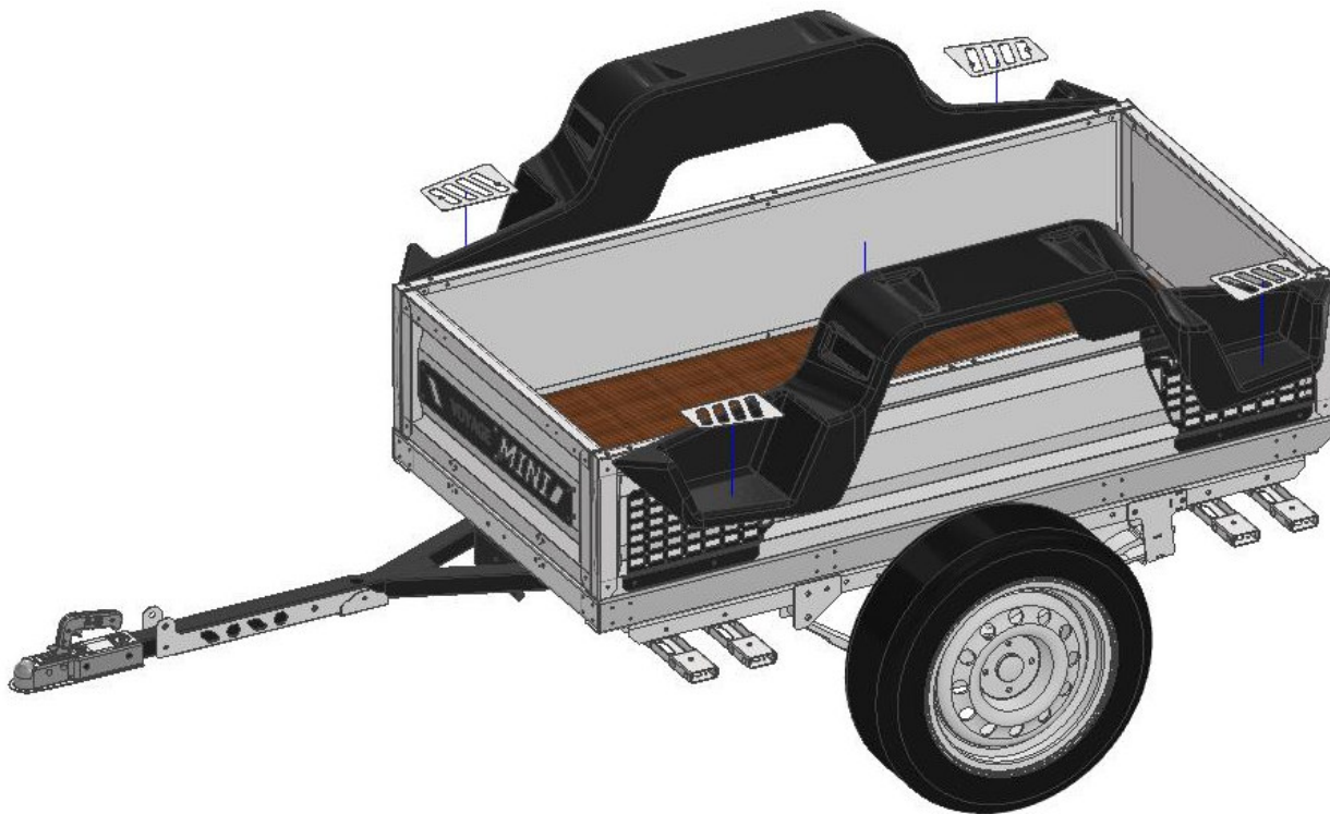
Рис.6 Установка колесных арок
