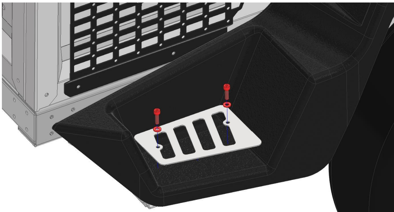
Рис.7 Установка колесных арок
