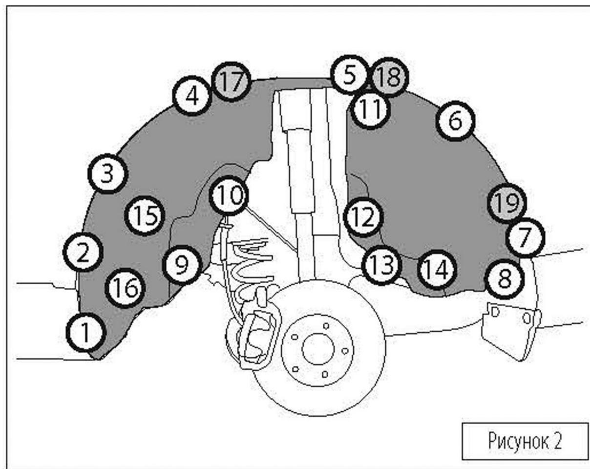
Зафиксировать подкрылок, используя элементы штатного крепежа соблюдая последовательность, указанную на рисунке 2 в кругах белого цвета (точки 1-15). В точке 16 установить саморез из комплекта поставки. **ВНИМАНИЕ!** В комплектациях без пластикового расширителя, зафиксируйте изделие в точках 17, 18, 19 используя штатные элементы фиксации.
