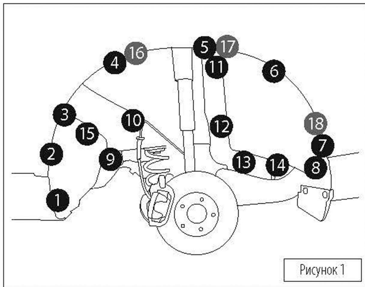
Снять колесо. Демонтировать штатные крепежные элементы в точках, отмеченных черными кругами на рисунке 1. **ВНИМАНИЕ!** В комплектациях без пластикового расширителя, произведите демонтаж крепежных элементов в точках 16, 17, 18. Установить подкрылок в арку. Заправить кромку подкрылка за кромку крыла и бампера.
