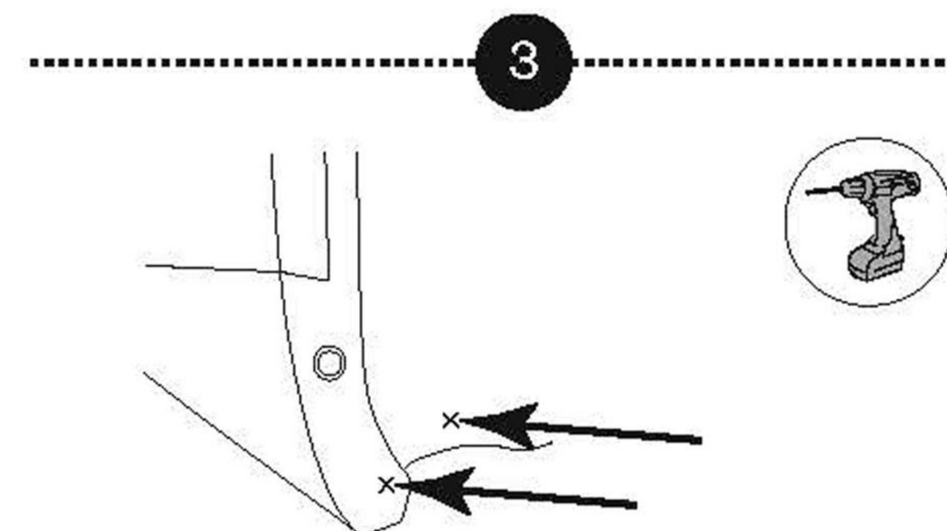
Используя сверло Ø 8 мм, просверлите
