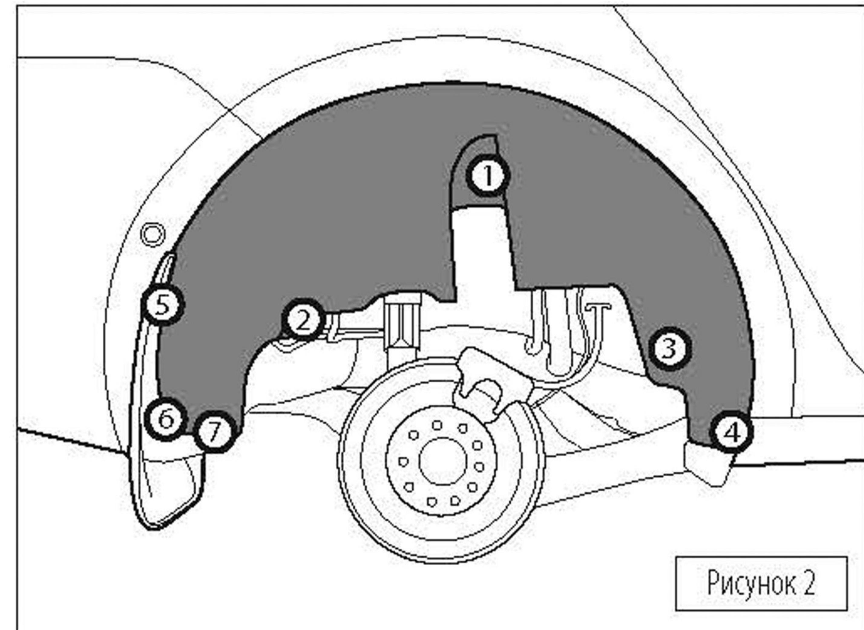
Снимите колесо. Произведите демонтаж штатных крепежных элементов в точках, отмеченных черными кругами на рисунке 1. В месте демонтажа точки 7 установите скобу из комплекта поставки (рисунок 1.1). Совместите отверстие в скобе со штатным отверстием. Установите подкрылок в колесную арку. Расположите подкрылок за брызговиком. Совместите крепежные места со штатными элементами крепления (отмечены белыми кругами на рисунке 2). Зафиксируйте подкрылок, используя эле-
